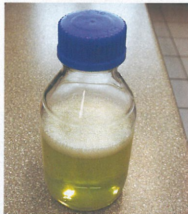
Po zatřepání se vzorkovnicí se měří čas, za který se na hladině vytvoří první lysinka a za který pěna zmizí úplně
