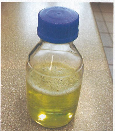
Po zatřepání se vzorkovnicí se měří čas, za který se na hladině vytvoří první lysinka a za který pěna zmizí úplně
