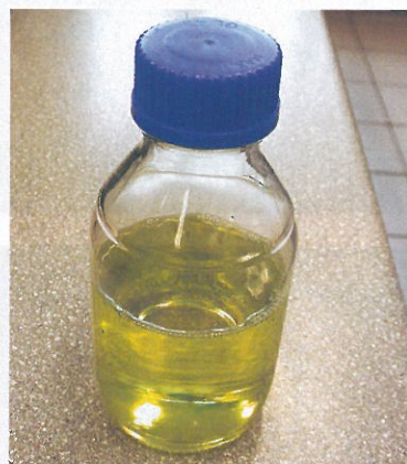
Po zatřepání se vzorkovnicí se měří čas, za který se na hladině vytvoří první lysinka a za který pěna zmizí úplně
